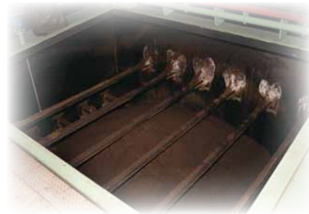
▲写真1 コーヒーかすを混合してバイオガス発生量を増加させます
