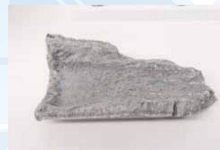
▲【写真1】配管の閉塞要因となるリンの結晶
